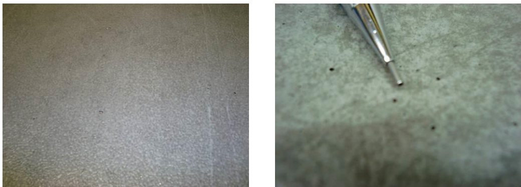
Abb. 5 Produkt B nach der Applikation (links: noch feucht und rechts: Poren offen)
